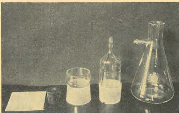
Abb. 1: Von links nach rechts: Dederonseide, Gummistopfen, Hülse, Kern und Saugflasche
