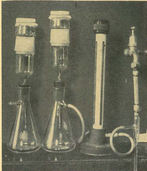
Abb. 2: Von rechts nach links: Wasserstrahlpumpe, Strömungsmesser, Saugflasche mit Testgefäß, Testgefäß ohne Saugvorrichtung
