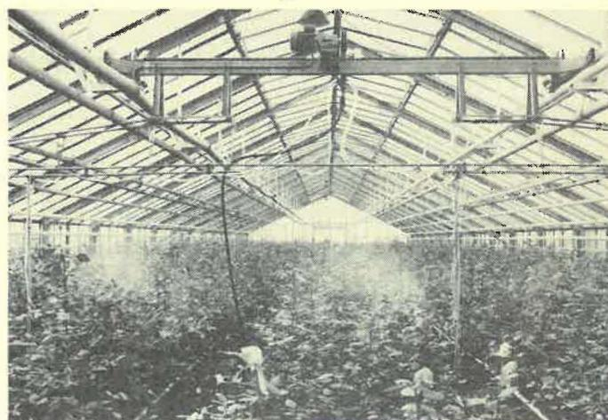
Abb. 1: Applikationseinrichtung während des Spritzens im Rosenbestand
