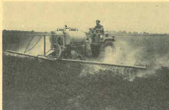
Abb. 11: Stäubeinsatz des S 293 zur Kartoffelkäfer-Bekämpfung (Werkfoto)
