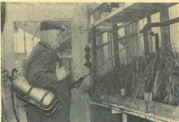
Abb 4: Verwendung der P 116 als Umhängespritze
