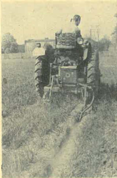
Abb. 8: Fangschlitzgerät mit Stäubezusatzeinrich- tung (Werkfoto)
