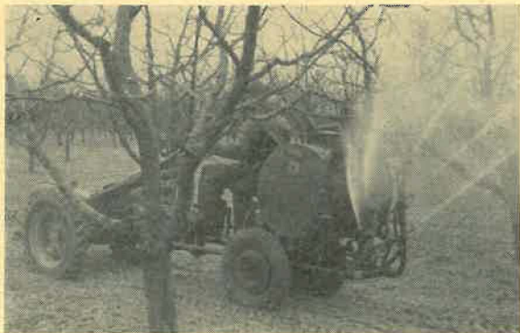
Abb. 10: S 240 mit Strahlrohrrahmen zur Spätwinterspritzung eingesetzt
