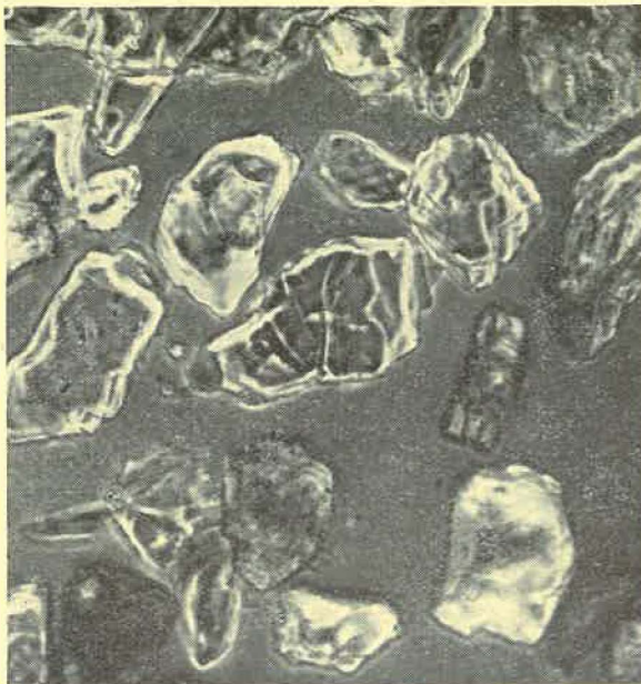
Abb. 3. Klinochloritschiefer: II. Spülzylinder, Teilchen zwischen 90 und 50 \mu . Gesamtgehalt an \text{SiO}_2 — 48,45% *) 1 mm aller Abbildungen entspricht 4 \mu
