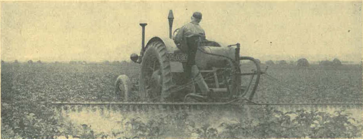
A b b. 3. Anbauspritze zum Schlepper RS 30.
