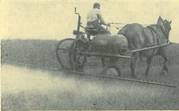
A b b. 1. Schaumnebelspritze PSN 6 bei der Spritzung mit Hormit gegen Unkraut
