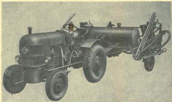
A b b. 2. Zapfwellen-Schaumnebelspritze P/SS 12 in Transportstellung.
