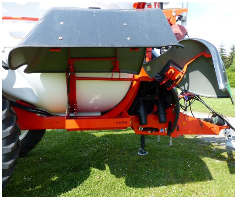
Abb.3: Rechte Geräteseite mit Ablagefach und Filtern.
