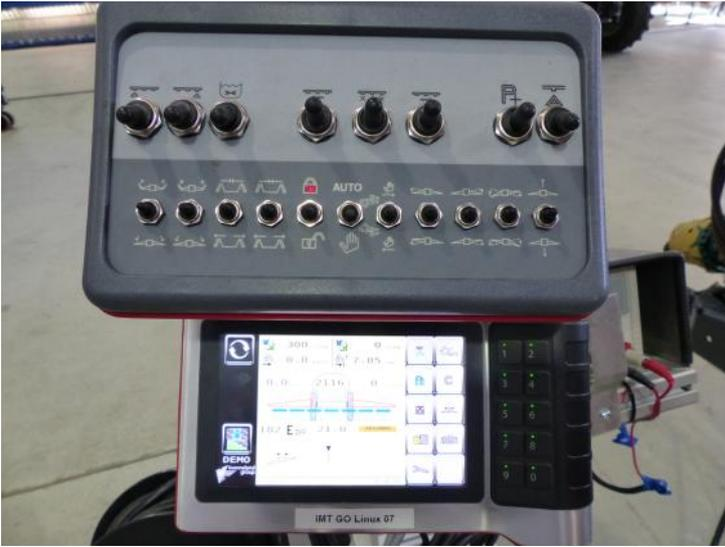
Abb.8: ISOBUS konformes Terminal „Tellus GO“ mit Schalttableau.
