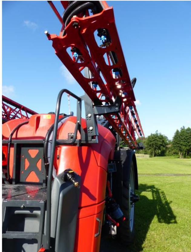
Abb.5: Seitlich geklapptes Gestänge mit gut geschützten Düsen.
