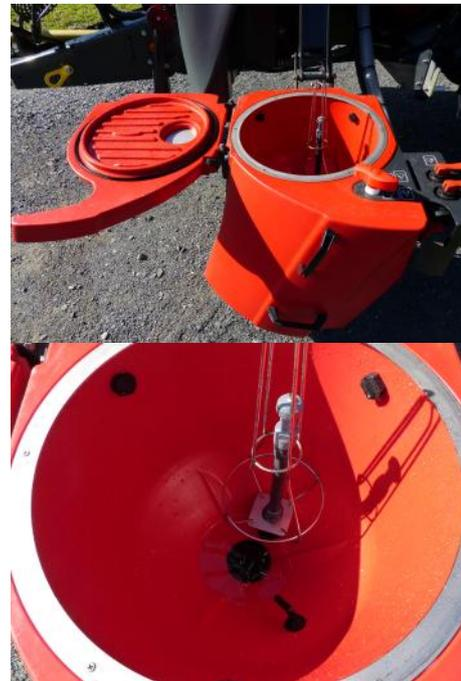
Abb.3/4: Ausgeklappte Einspülschleuse auf der linken Geräteseite.
