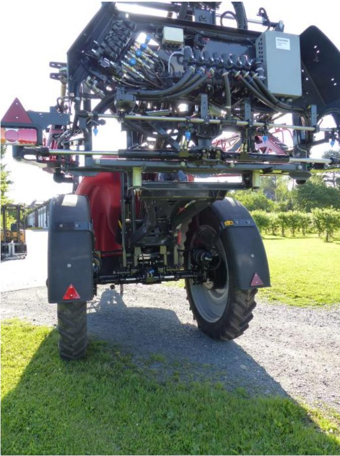
Abb.2: Zentrales Gestängesegment und Gestängehebeeinrichtung.
