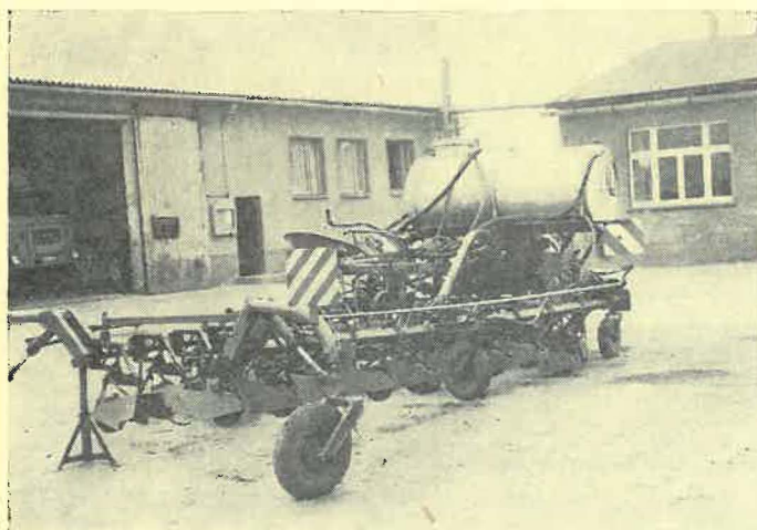
Abb. 3: Unterblattspritzeinrichtung auf der Basis Eigenbaubandspritze (VEG Hadmersleben)
