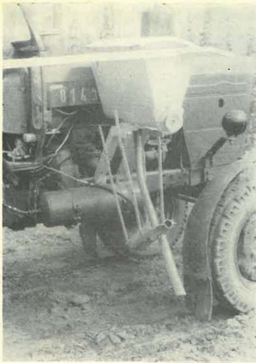
Abb. 1: Traktor MTS 50 mit angebaurem Granulatstreugerät
