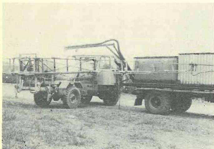
Abb. 2: Pflanzenschutz-LKW „Robur“ des ACZ Zittau bei der Feldrandbeladung durch die mobile Misch- und Belademaschine
