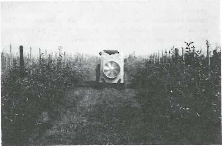
Abb. 10: Sprühgerät mit hochgesetztem Axialgebläse und Luftführungskasten
