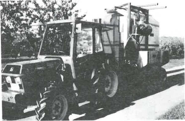
Abb. 4: Recycling-Spritzgerät bei Straßenfahrt
