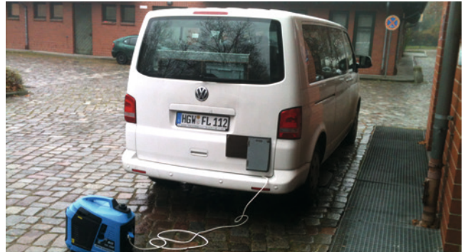
Abb. 2: Bus im Generatorbetrieb.
