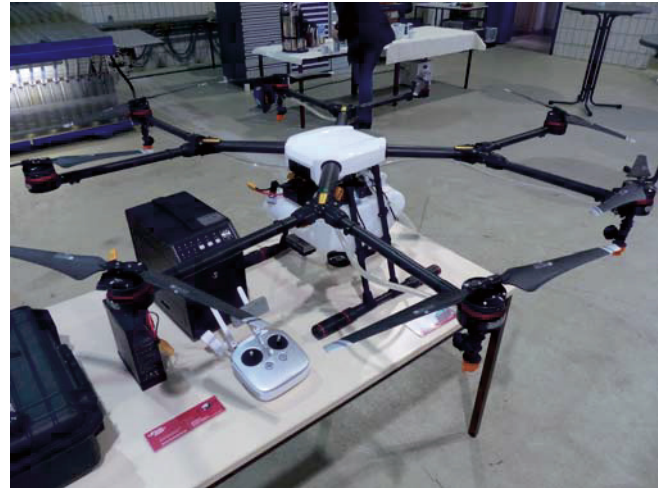
Abb. 2. Die Drohne DJI Agras-MG1 ist ein Oktokopter und wurde speziell für die Applikation von Pflanzenschutzmitteln in China entwickelt. Die Düsen sitzen direkt unter den Rotoren.
