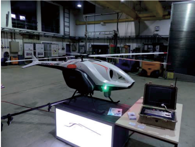
Abb. 1. Das UAV DragonFly der Firma Aveox erinnert an einen Hubschrauber mit Spritzgestänge. Es ist schwerer, als klassische Drohnen, hat aber auch eine längere maximale Flugzeit und ein höheres Tank Fassungsvermögen.
