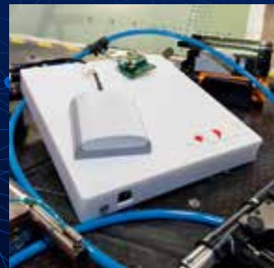
Diese Recheneinheit samt Antenne sendet bei Airbus Informationen zwischen dem Computer und dem Bohrer hin und her
