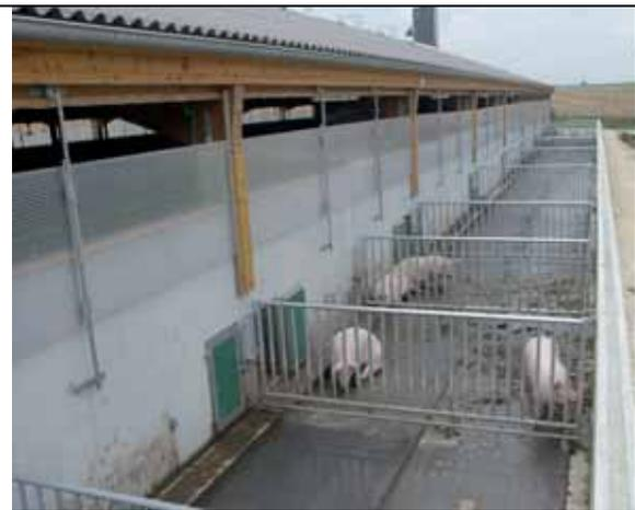
Betrieb 5: Auslauf planbefestigt, Klappschieber zur Entmistung
