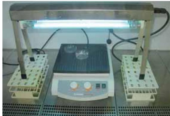
**Abbildung 3:** Experimenteller Aufbau der UV-Bestrahlung zur Erzeugung von Mutationen
