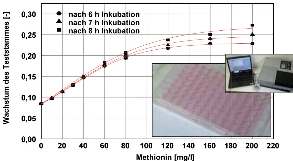
Abbildung 4: Kalibrationskurve des mikrobiologischen Methionin-Nachweises mit *E. coli* B834 im Mikrotiterplatten-Maßstab. Fotos: Mikrotiterplatte, Plattenreader mit automatischer Datenaufnahme und Verarbeitung
