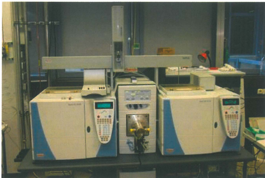
Abb. 5: Das zum selektiven Nachweis von PCDD/F und PCB in Fleisch(erzeugnissen) und Eiern verwendete GC/HRMS-System (Fa. Thermo Fisher Scientific, Typ DFS)
