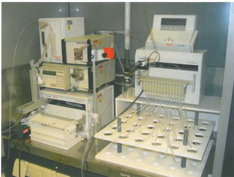
Abb. 2: Das zur Abtrennung von Fett und Biopolymeren eingesetzte Gelpermeations-Chromatographie-Analysensystem (Fa. Abimed(Gilson))
