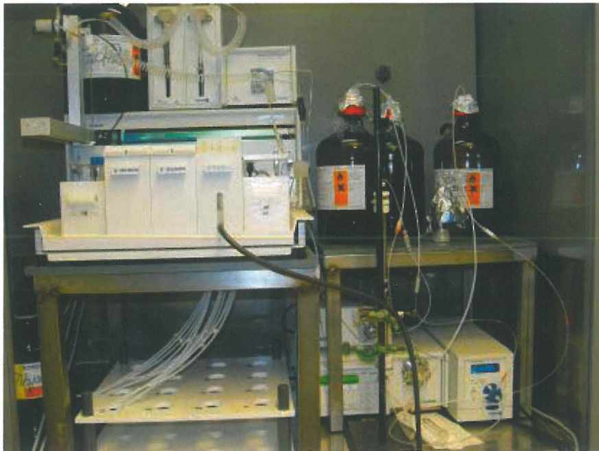
Abb. 3: Das zur Reinigung und Anreicherung der PCDD/F und PCB eingesetzt modifizierte Chromatographie-Analysensystem mit SPE-Einheit und Aktivkohlesäule (Fa. Gilson, Typ ASPEC modifiziert)
