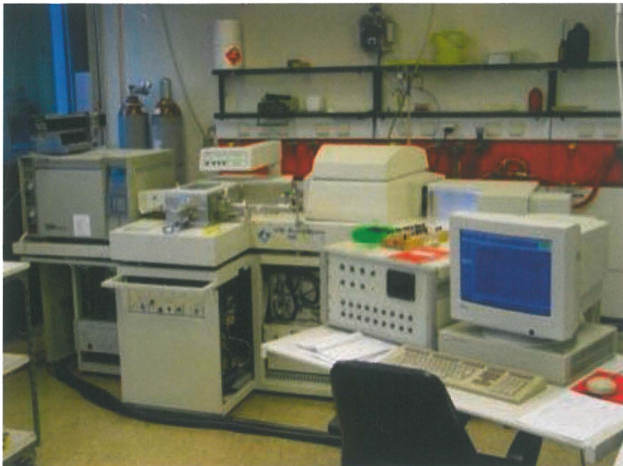
Abb. 4: Das zum selektiven Nachweis von PCDD/F und PCB in Futtermitteln verwendete GC/HRMS-System (Fa. VG, Typ Autospec)
