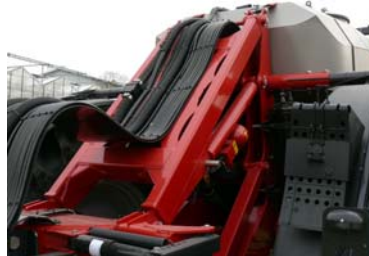
Abb. 6 und 7: Das Gestänge lässt sich bis auf 350 mm absenken. Die Hydraulik- und Flüssigkeitsschläuche sind sauber über den Tragrahmen verlegt.
