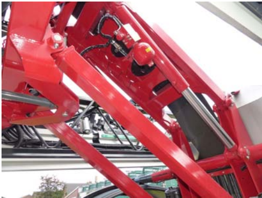
Abb. 8: Das Parallelogramm-Hubgerüst ist mit Stickstoffdämpfern bestückt, sodass harte Stöße während der Arbeit nicht direkt an das Gestänge weitergegeben werden.
