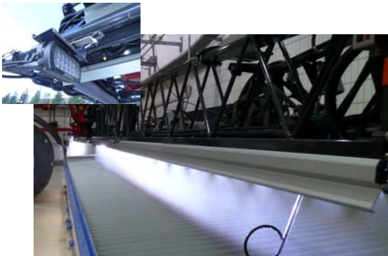
Abb. 9: Gute Ausleuchtung der seitlichen Ausleger durch zwei LED-Strahler am Gestängemittelteil.
