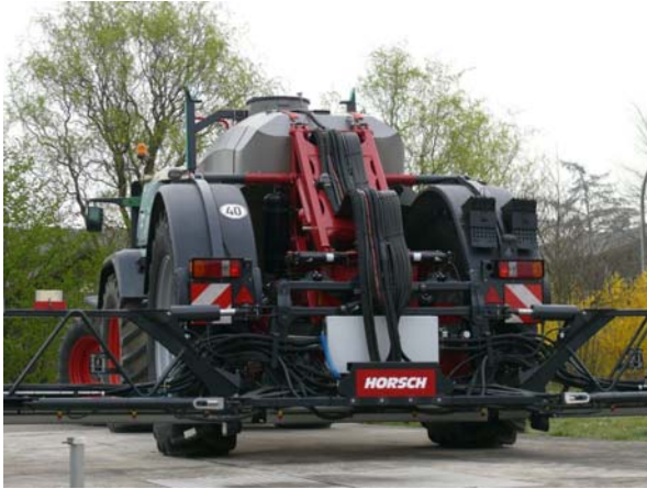
Abb. 6 und 7: Das Gestänge lässt sich bis auf 350 mm absenken. Die Hydraulik- und Flüssigkeitsschläuche sind sauber über den Tragrahmen verlegt.
