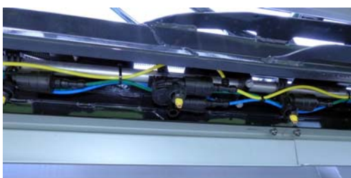
Abb. 5: Pneumatische Doppel- und Einfachdüsenkörper lassen sich zu einem 25 cm Düsenverband kombinieren.
