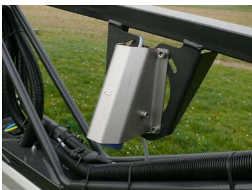
Abb. 4: Insgesamt vier Ultraschallsensoren sorgen für eine gute Abtastung der Zielfläche.
