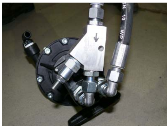
Abb. 4: Die Drehzahl der Pumpe wird über ein Strombegrenzungsventil fest eingestellt.
