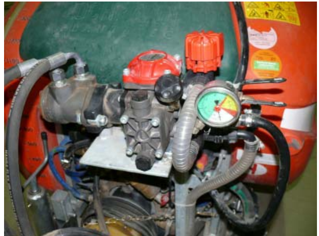
Bild 2: Nachrüstsatz 11600842 für Sprühgeräte
