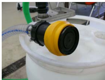
Abb. 6 und 7: Die Entnahme kann über eine Bajonettkupplung aus Großbehältern erfolgen. Die Einspeisung in das Spritzgerät erfolgt über eine tropffrei arbeitende Kupplung.
