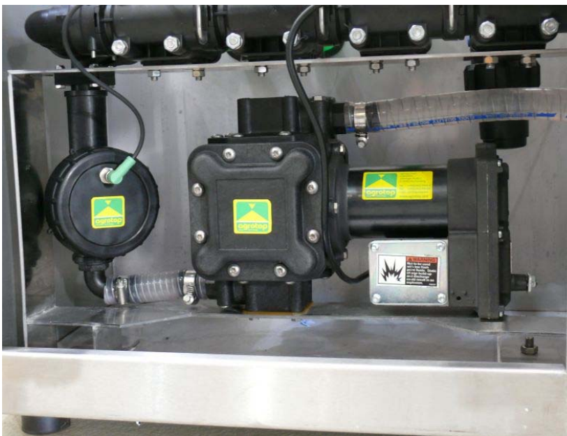
Abb. 4: Der Durchflussmesser ist mit einer automatischen Lufterkennung ausgestattet und stoppt den Betrieb bei zu viel Luft in der Dosierleitung. Die Pumpe hat eine interne Überdrucksicherung.
