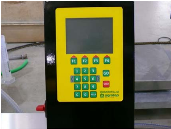
Abb. 2: Die zentrale Steuereinheit ist mit Folientastatur und Flüssigkristallanzeige ausgerüstet.
