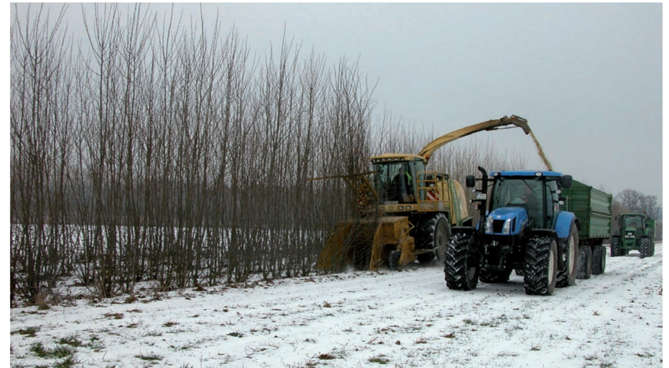
Abbildung 3: Häcksler bei der Ernte der Baumstreifen. 152 Tonnen Hackschnitzel mit einem Wassergehalt von ca. 55 % wurden auf der 18 ha großen Agroforstanlage (1,9 ha Baumstreifen) in Wendhausen im Januar 2014 geerntet. Das Holz wurde in einem 7 km entfernten Biomasseheizkraftwerk in Braunschweig zur Wärmezeugung verwendet. Die Menge reichte für 500 Megawattstunden, damit können etwa 375 Drei-Personen-Haushalte einen Monat lang mit Fernwärme versorgt werden.
