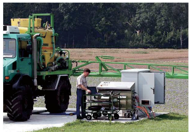
Abb. 5. Aufbau-Feldspritzgerät auf dem Schwingungsprüfstand.
