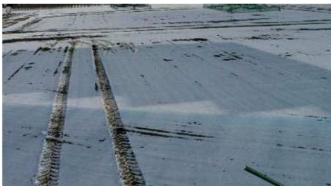
Abb. 6. Demonstration einer automatischen Teilbreitenschaltung mit schwarzem Farbstoff auf Schnee.
