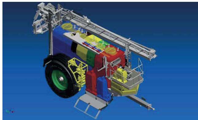
Abb. 10. Feldspritzengerät mit mehreren Systemen zur Direkteinspeisung.
