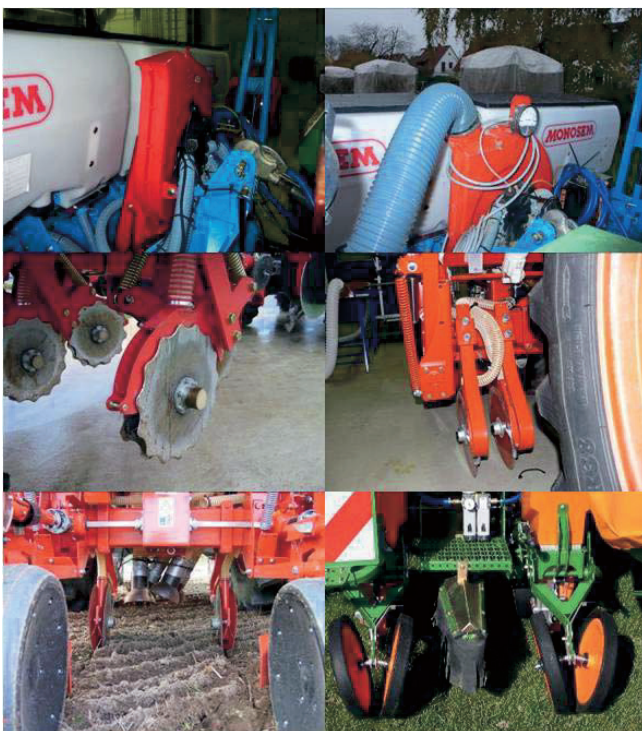
Abb. 4. Technische Lösungen zur Ableitung der Abluft bei Sägeräten: Obere Reihe: links – ohne Leiteinrichtung (Abluftöffnung mit Schutzklappe) rechts – das gleiche Gebläse mit Leiteinrichtung Mittlere Reihe: Beispiele für Ableitung in den Boden über Düngerschare Untere Reihe: Beispiele für Ableitung auf den Boden über Diffusoren.
