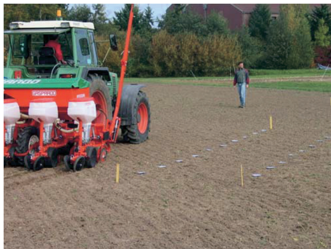
Abb. 2. Prüfung eines Maissägerätes hinsichtlich Abdrift von Stäuben.
