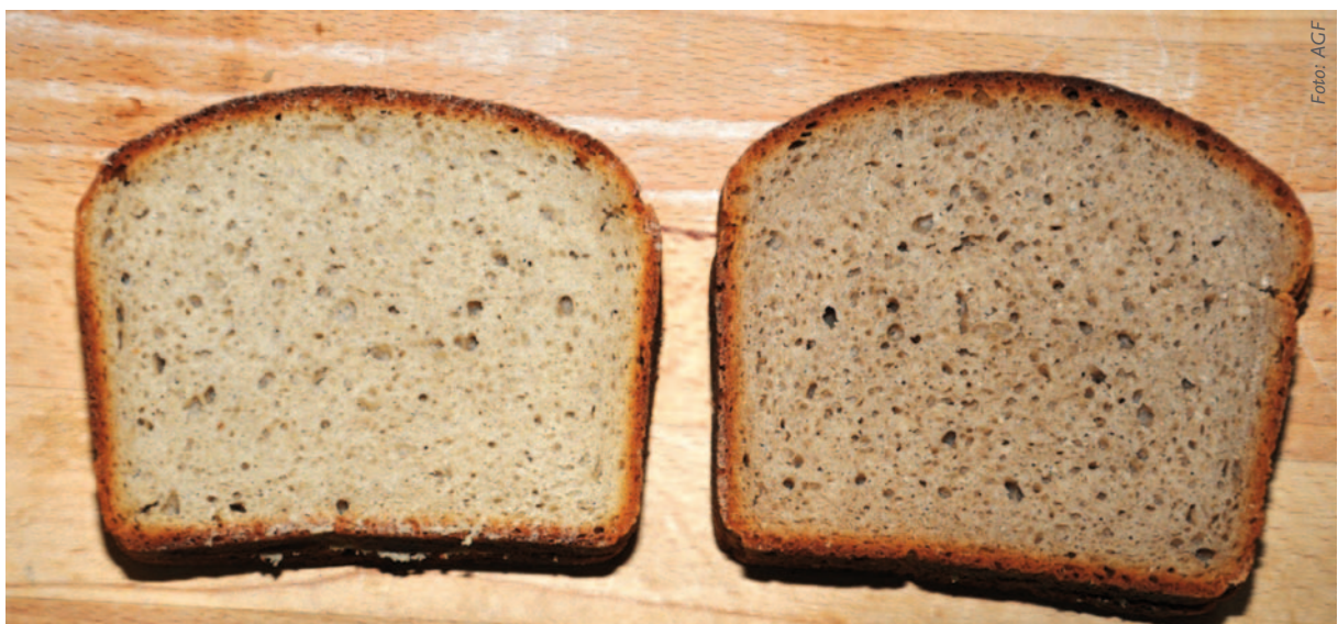
In Detmold wurden Roggenmehlbackversuche mit stark differierenden Fallzahlen durchgeführt: Brotscheibe G (links, Fallzahl 319) und Brotscheibe A (rechts, Fallzahl 115).
