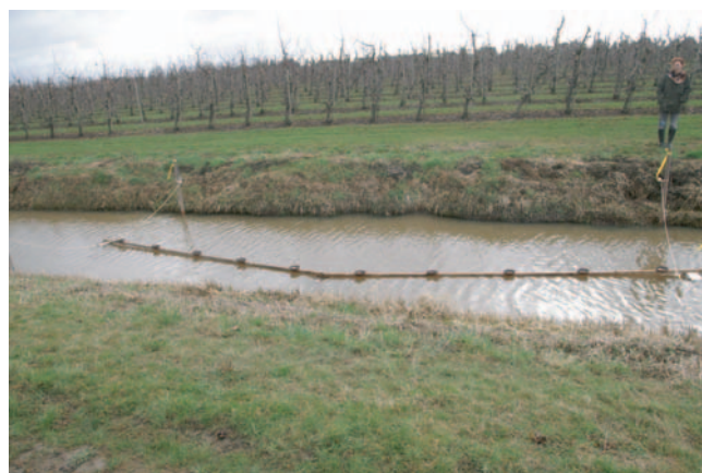
Abb. 7. In Niedersachsen verwendete Stellagen, auf denen vor der Applikation 10 Petrischalen-Unterteile (Ø 8,8 cm) im Abstand von 1 m aufgestellt wurden, um die Deposition der Abdrift zu erfassen.
