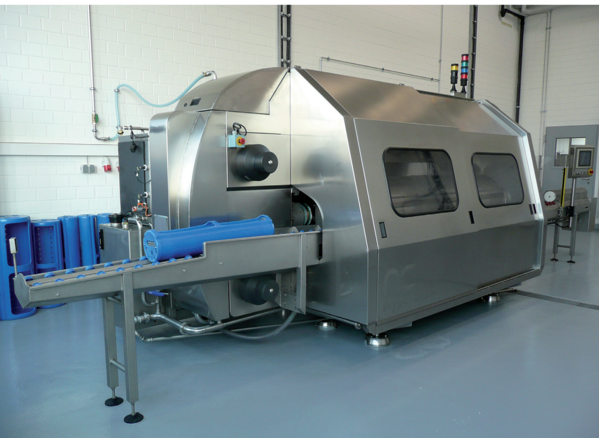
Abbildung 1: Hochdruckanlage Wave 6000/55 (Fa. Hiperbaric)
