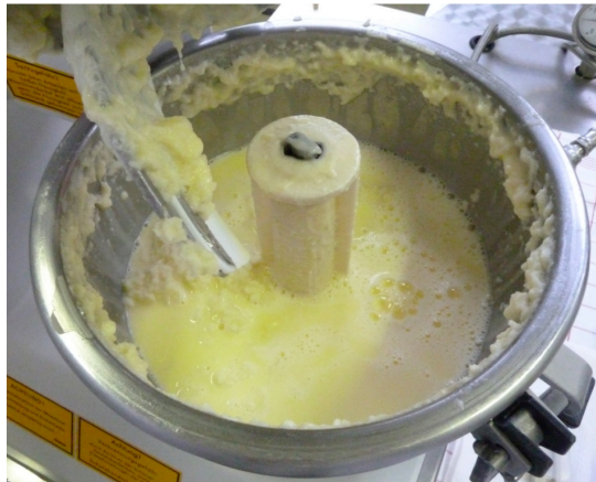
Abb. 4.57.: Schmelzkäseteig kurz vor der Abfüllung. Auf der Oberfläche ist ungebundenes Wasser zu sehen. Die Oberfläche wirkt rauh und stückig.
