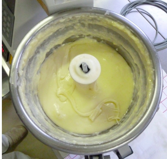
Abb. 4.56.: Homogener Schmelzkäseteig kurz vor der Abfüllung. Die Oberfläche ist glatt und glänzend
