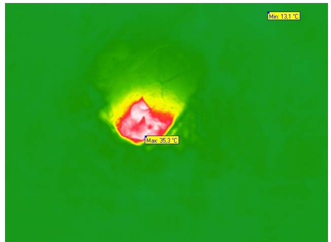
Nest erkennbar; Temperaturdifferenz 22,2°C
