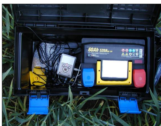
Abbildung 15: Technik zur Observierung mittels Infrarotkamera (Bild links: Datenrecorder und Autobatterie; Bild rechts: Infrarotkamera)
