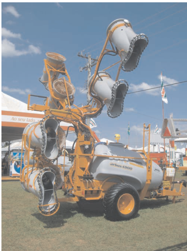
Abb. 2. Sprühgerät mit 8 Axialgebläsen.
