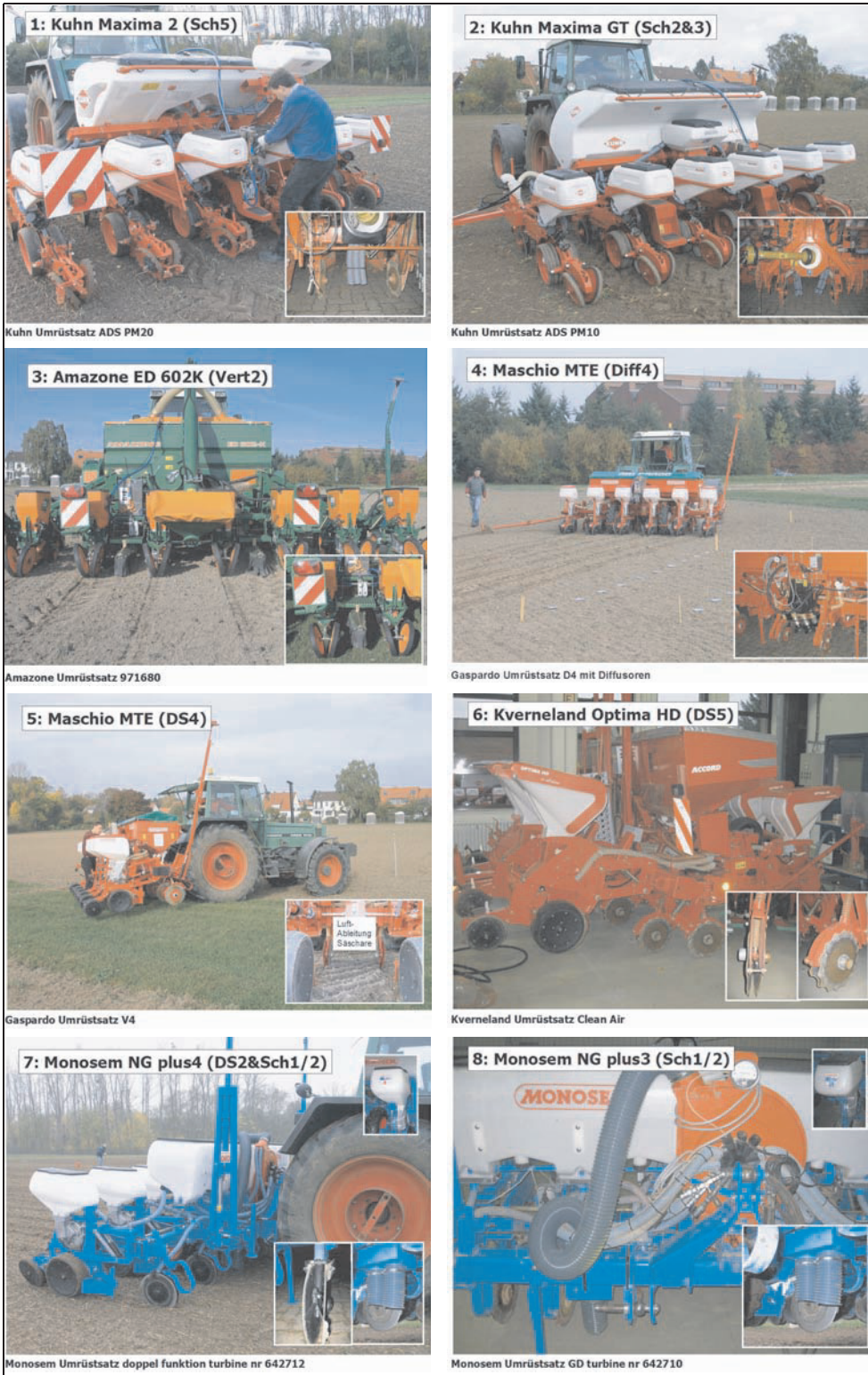
Abb. 8. Abbildungen der Mais-einzelkornsäegeräte mit modifizierter Gebläseabluftführung für die eine 90%ige Abdriftminderung nachgewiesen wurde und die in der Liste abdriftmindernde Maissäegeräte eingetragen sind (Stand: März 2009).
