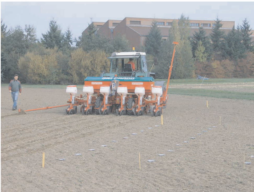
Abb. 3. Traktor mit Maissägerät bei Abdriftmessungen im Freilandeinsatz.
