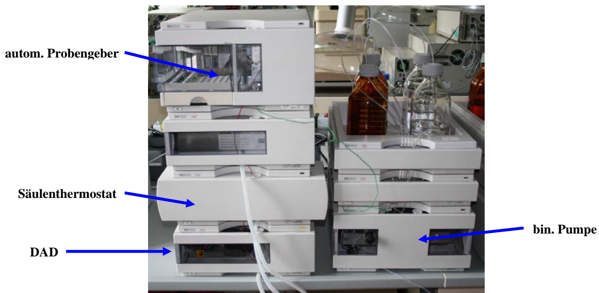
Abb. 7: HPLC-System „1100“ von Agilent mit automatischem Probengeber, binärer Pumpe und DAD zur Analyse des Glucosinolatgehaltes und des Glucosinolatverteilungsmusters in Brassicaceen.
