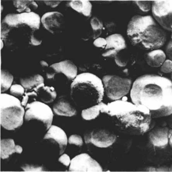
Abb. 20. Plastische Deformationen in einem Cu-Preßling.
