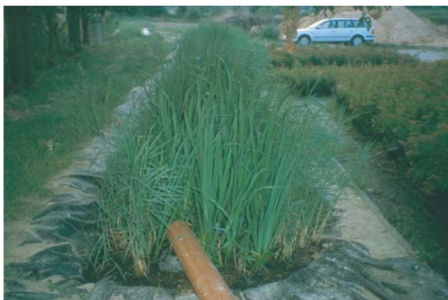
Abb. 4.2. Becken 1: Schilf und Segge auf Substrat aus einer Blähton Erde Mischung
