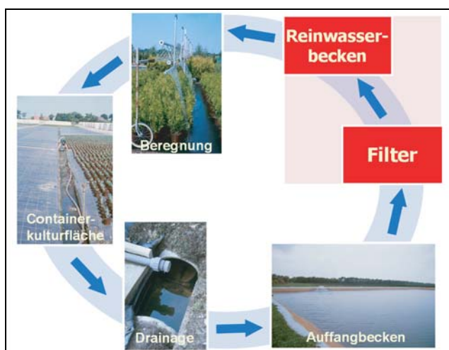
Abb. 1. Schematische Darstellung eines geschlossenen Bewässerungskreislaufs in einer Containerbaumschule mit Filtrationsanlage.
