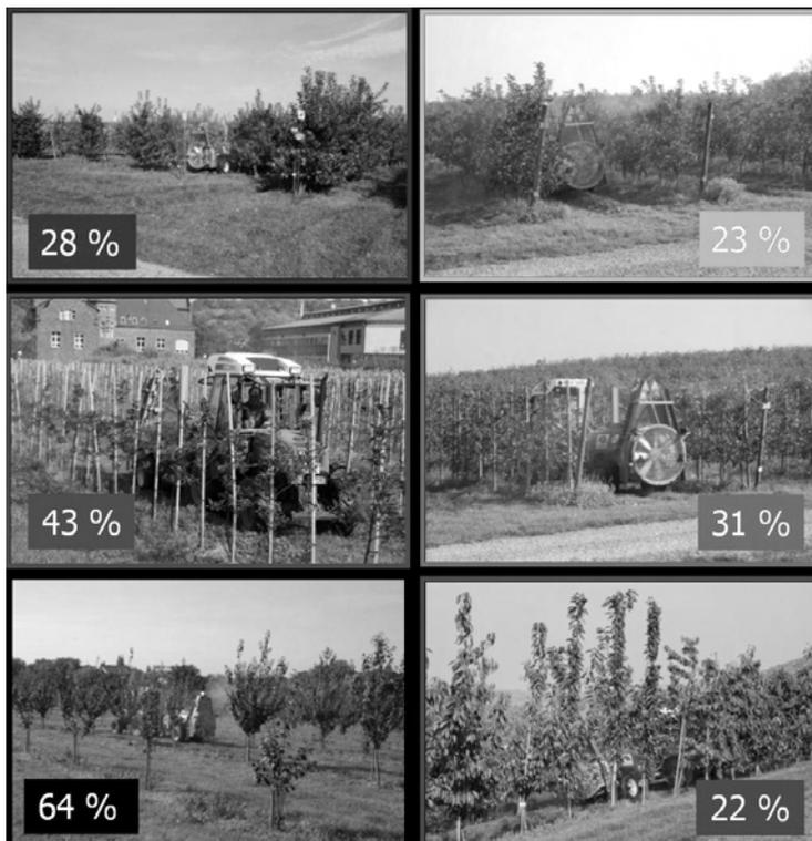
**Abbildung** Einsparungspotenziale an Pflanzenschutzmitteln am Beispiel eines Obstbauprühgerätes mit sensorgesteuerten Düsen (ECO-Reflex; Firmen: Wanner und Müller-Elektronik) zur Lückenschaltung
