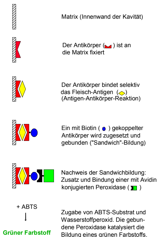
Abb. 1: Funktionsweise des ELISA-Tests
