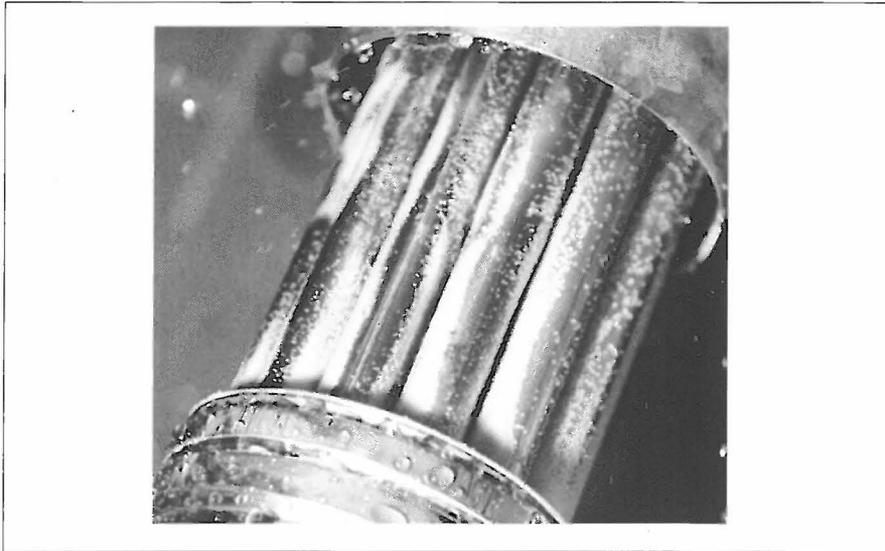
Abb. 2: Belagbildung im Mantelraum der Vorwärmaßeilung nach der Produktion, vor Wasser-
