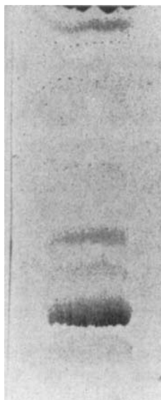
Abb. 1. Dünnschichtchromatogramm der Weizenlipide Trennschicht: Kieselgel G; Laufmittel: Chloroform : Methanol : Wasser = 65 : 25 : 4; Sprühreagenz: Molybdänsäure-Reagenz nach Dittmar und Lester
