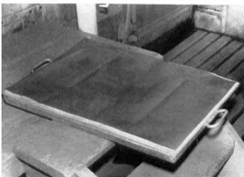
Abb. 3. Gefrierblech mit naturbelassenen Fischstücken in Klarsicht-Schrumpfverpackung, vorbereitet zum Horizontalplatten-Gefrieren
