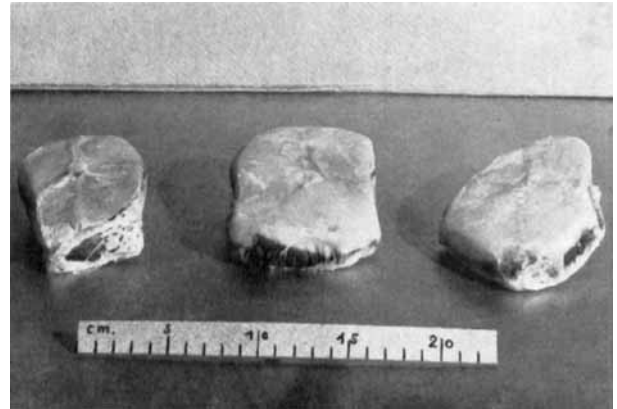
Abb. 4. Im Horizontalplatten-Gefrierapparat tiefgefrorene, naturbelassene fangfrische Fischstücke (Seehecht in Klarsicht-Schrumpfverpackung, Portioneneinheitsgewicht etwa 200 bis 250 g)
