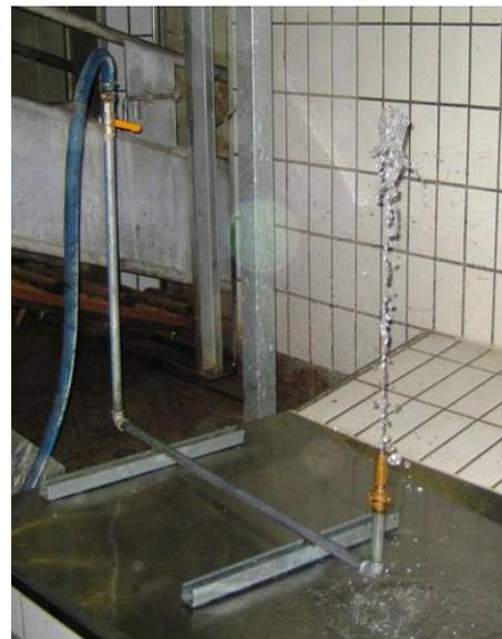
Abb. 1: Heißwasserstrahldüse in der Nachentblutestrecke zur Prüfung des Empfindungsvermögens gestochener Schweine
