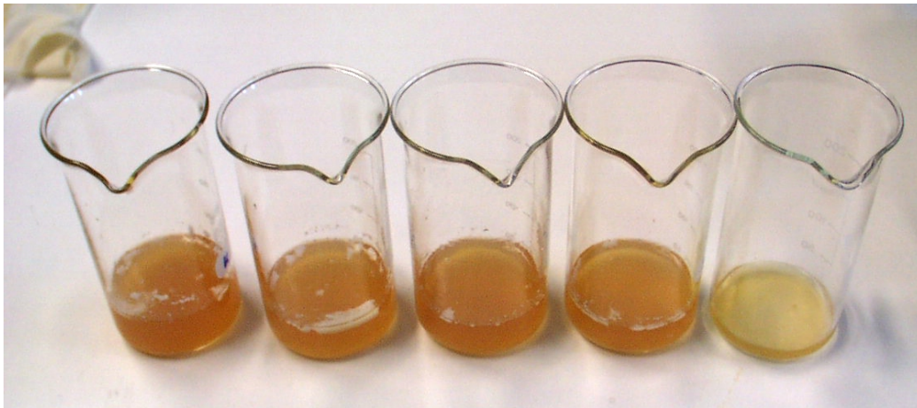
Abb. 1: Geleeabsätze der verschiedenen Chargen einander gegenübergestellt (von links (= Kontrolle) nach rechts (= 5 % Faserzusatz) in aufsteigender Reihenfolge der Faserzusatzmenge)
