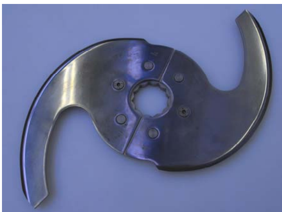
Abb. 1: Beide Messer einer Messerebene „Kopf an Kopf“ auf der Haltescheibe verschraubt
