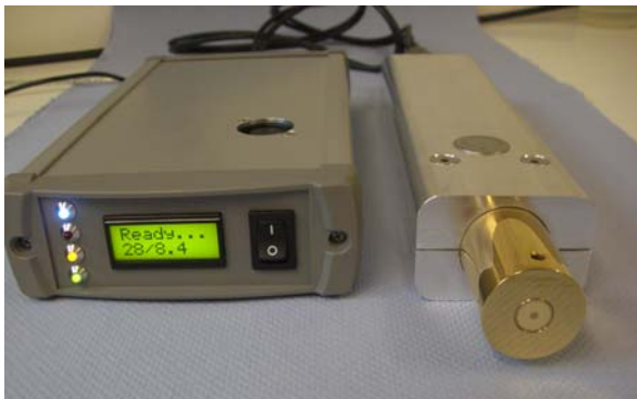
Abb. 1: Hochfrequenz-Impulsgenerator und -Messsonde
