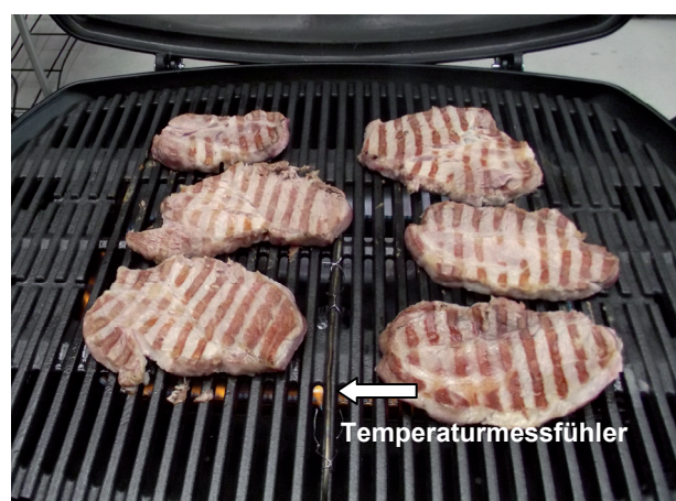
Abb. 1: Messung der Temperatur auf Höhe des Grillrostes im Falle der Zubereitung von Schweinenackensteaks auf dem Gasgrill
