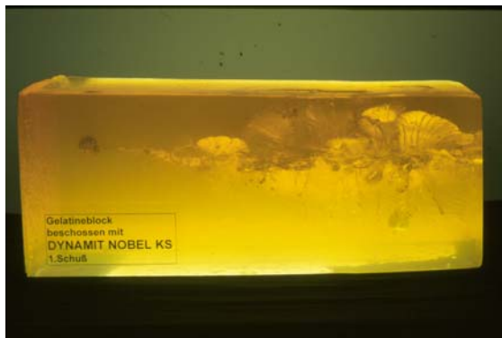
Abb. 4: Ein mit konventioneller Kegelspitzmunition beschossener Gelatineblock (Seitenansicht)
