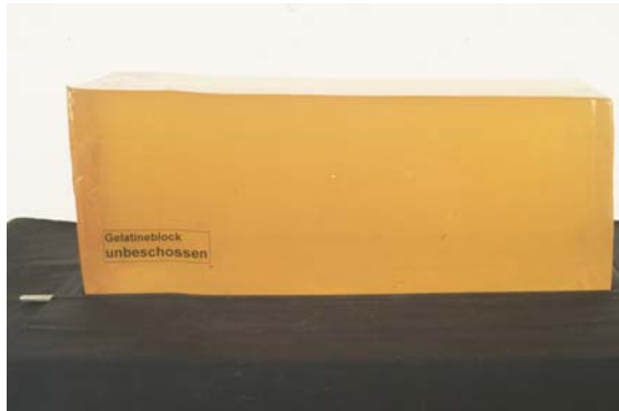
Abb. 2: Gelatineblock zur Durchführung von Beschussversuchen
