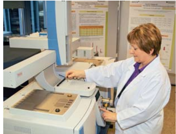
Der automatische Probengeber der GC-MS wird gestartet
