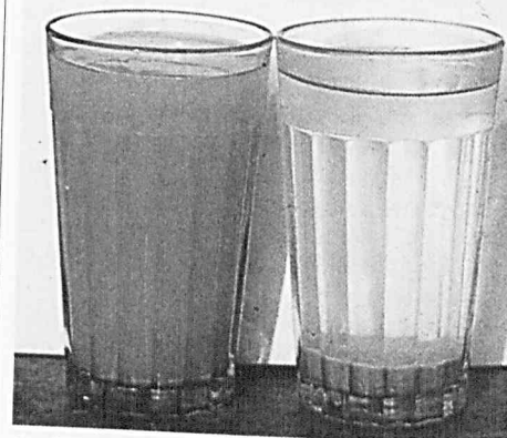
3: Wasser eines Hafirs vor und nach der Behandlung mit Samen von Moringa oleifera (Foto: Dr. S. A. A. Jahn)
