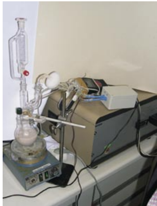
Abbildung 2: Apparatur zur Bestimmung von CO in Fisch im Original - Picture of the equipment for the detection of CO
