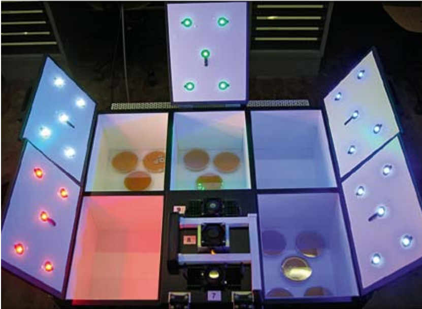
Abb. 5: Am MRI entwickelte Lichtbox zur Analyse des Einflusses der Lichtwellenlänge auf die Ochratoxinbildung.
